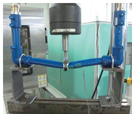
写真 給水青ポリ管の繰返し曲げ試験
